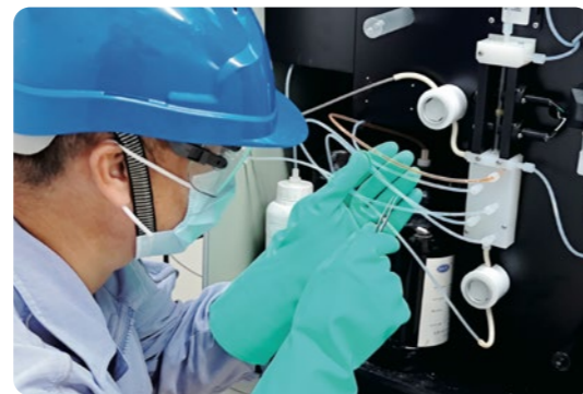
现场班组检查蠕动泵进出口端橡胶毛细管状态
